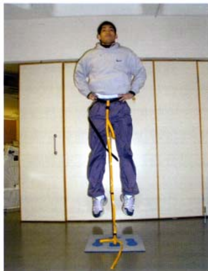
腿部爆發力測試—垂直跳躍測試儀
