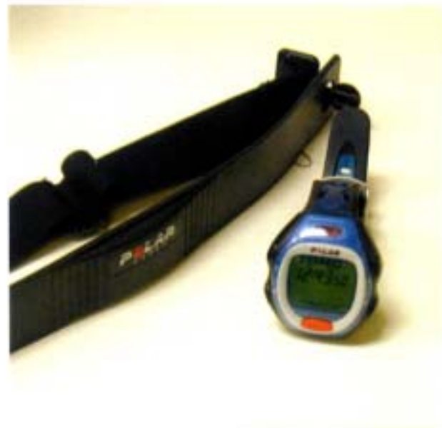
圖 5.2 心率遙測設備
